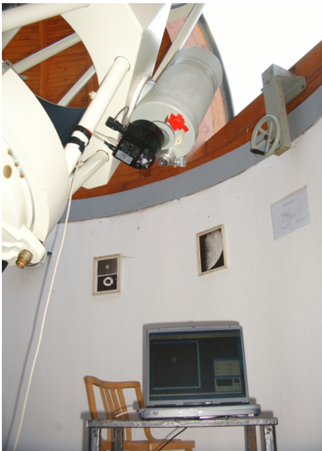
Obr. 3.2: CCD kamera SBIG ST-9XE umiestnená na fotokomore Zeiss Spiegelobjektiv 5,6/1000 v kupole Observatória Hlohovec a pripojená k počítaču
